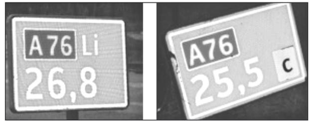
**Bild 2:** Niederländische Streckenkilometrierung (Fotos: SKOTTKE)
