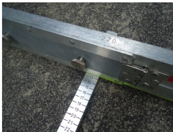
Bild 84: Maximal festgestellte Querebenheit von mehr als 12 mm
