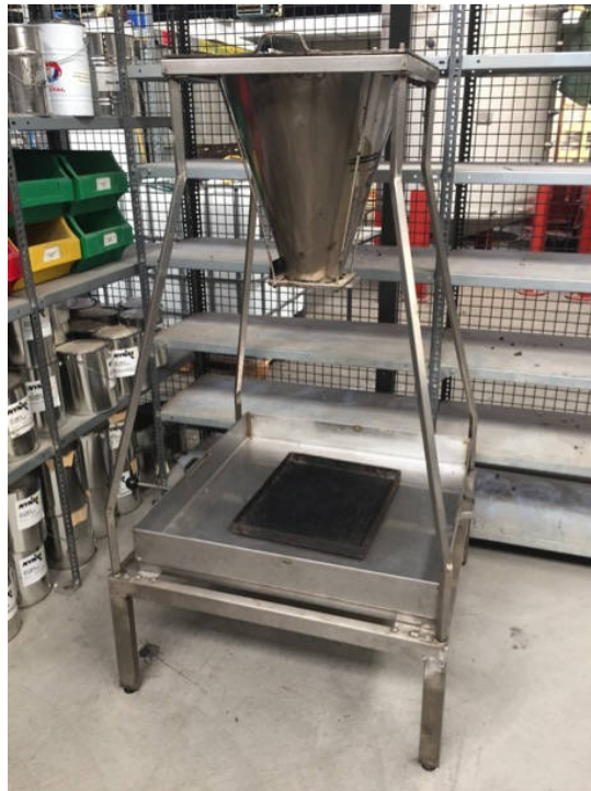
Bild 95: Entmischungsapparatur nach DIN 12697-15
