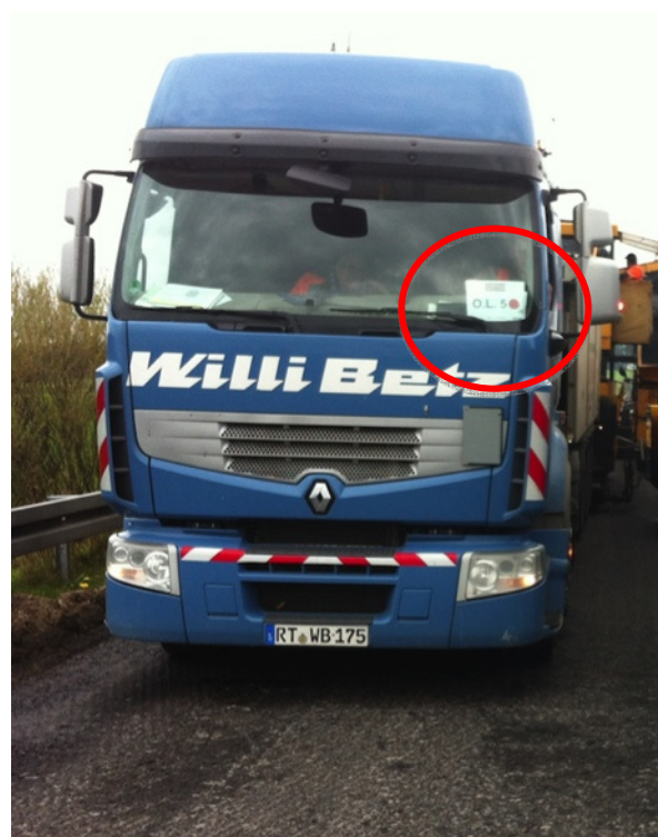
Bild 113: Vordere Markierung eines Mischgut-Transportfahrzeuges
