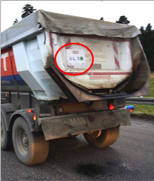
Bild 114: Hintere Markierung eines Mischgut-Transportfahrzeuges
