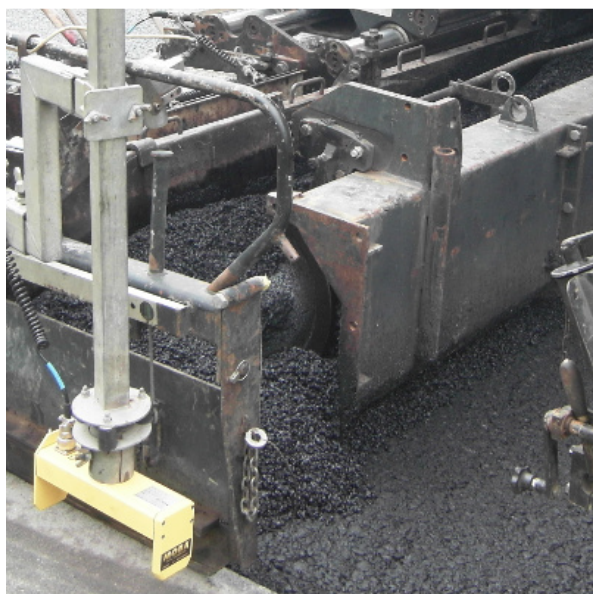
Bild 22: Standardaufbau der Kanalbleche an einer Bohle
