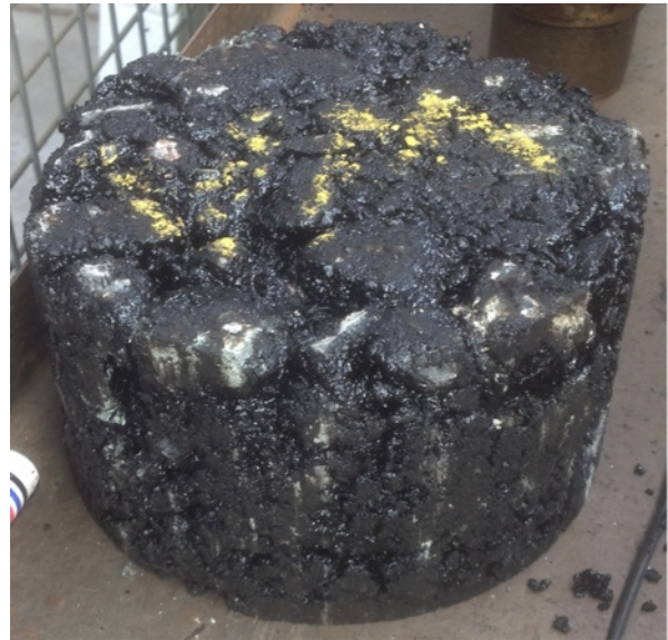
Bild 8: Beispiel für Kornzertrümmerung und ungefüllte Hohlräume an MPK WA1
