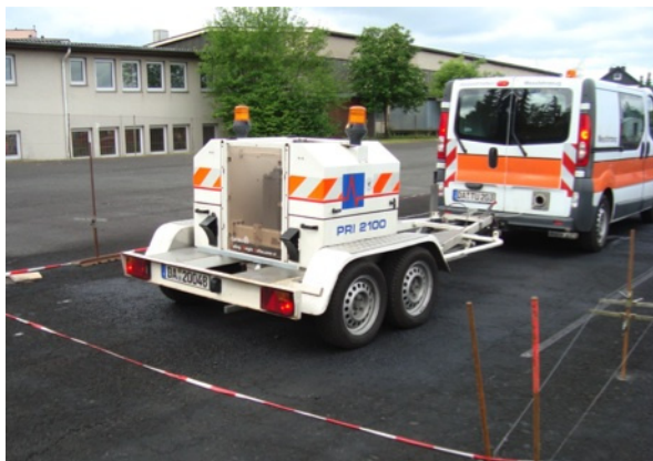
Bild 48: FWD-Messung an den Unterlagen der Versuchsfelder
