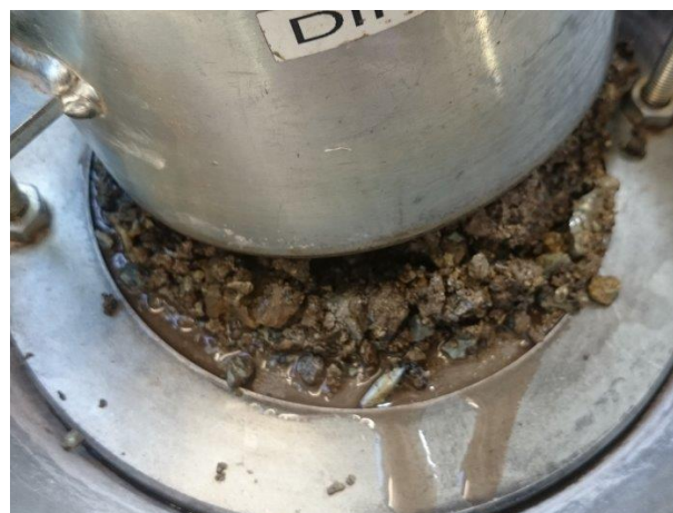
Bild 2: Entwässerung einer ungebundenen Baustoffgemischprobe während eines Proctorversuches
