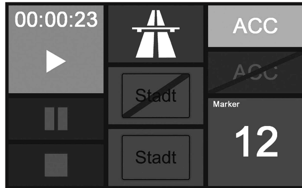
Bild 43: Touchscreen des Tablet-PCs für die Registrierung der Fahrbeobachtung. Die Felder haben gut unterscheidbare Farben und sind so groß, dass sie auch bei unruhiger Fahrt noch gezielt gedrückt werden können. © MTO
