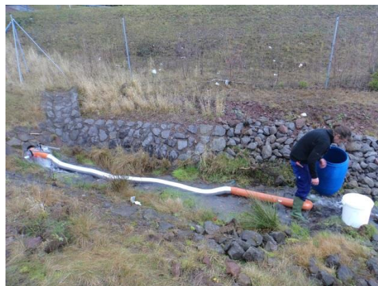
Abbildung 2: Temporäres Messwehr Rennsteig Nord
